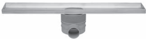
Easy Drain Multi inbouwdeel zonder rooster, waterslot 30/35/50mm 9.8x70cm | inb. diepte vanaf 79mm m. zijuitloop | EDMI700 | artikel 2301373
